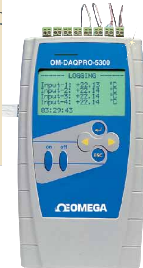
OM-DAQPRO-5300, 含传感器, 图片小于实际尺寸
